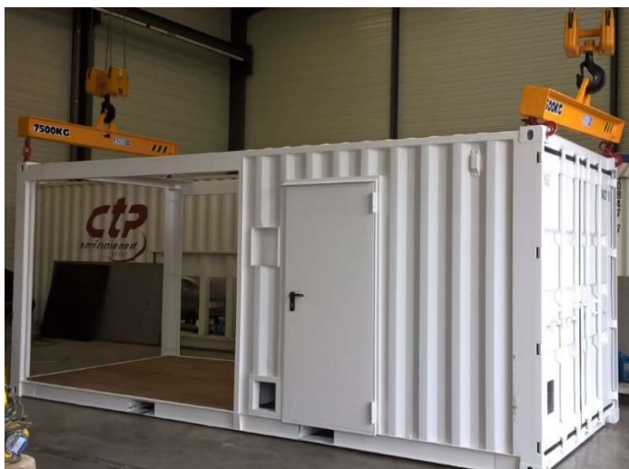
Figure 8: Levage par les coins « ISO » du container à l'aide d'un palonnier
