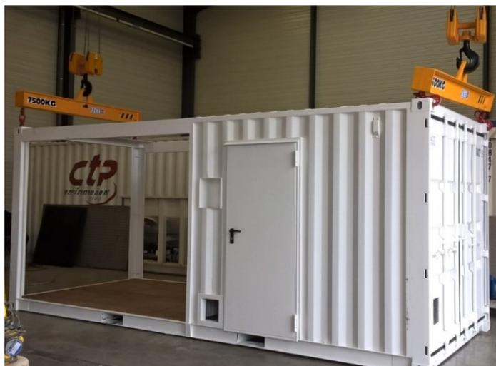
Figure 7: Levage par les coins « ISO » supérieurs du container à l'aide d'un palonnier
