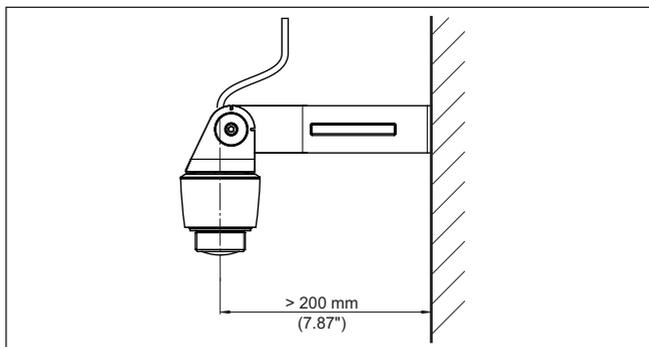
Fig. 4: Montage par une équerre de montage
