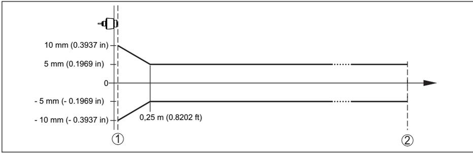
Fig. 25: Écart de mesure sous conditions de référence <sup>10)</sup>
