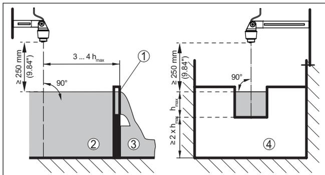
Fig. 15: Mesure du débit avec déversoir rectangulaire:  $h_{max}$  = remplissage max. du déversoir rectangulaire
