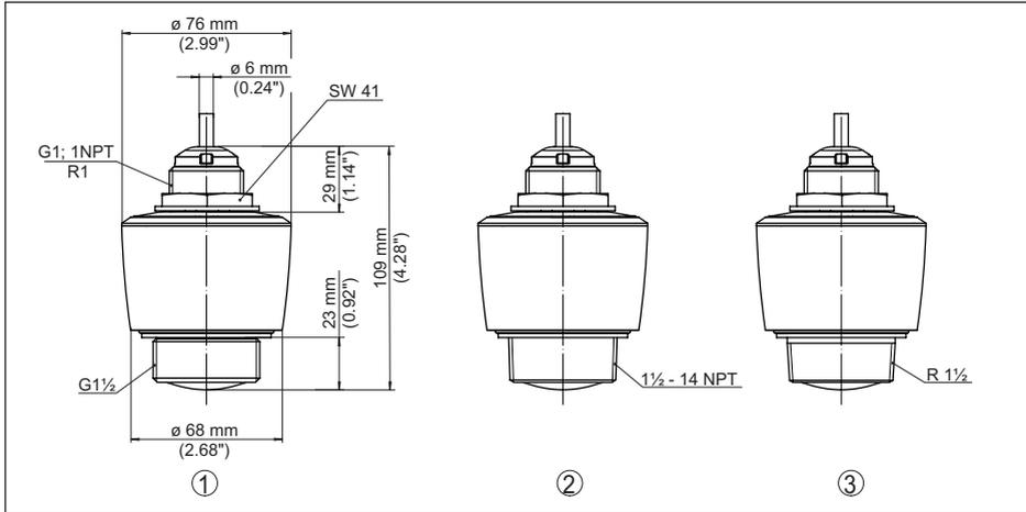
Fig. 26: Encombrement VEGAPULS C 11
