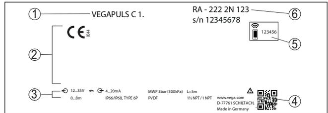
Fig. 2: Présentation de la plaque signalétique (exemple)
