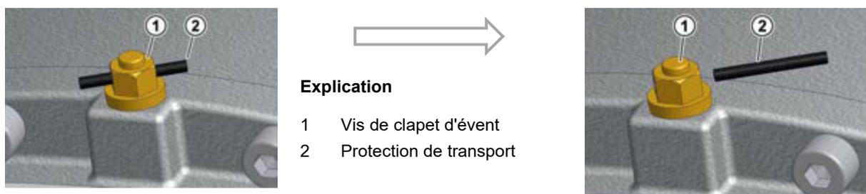
Figure 3: Activation de la vis du clapet d'évent
