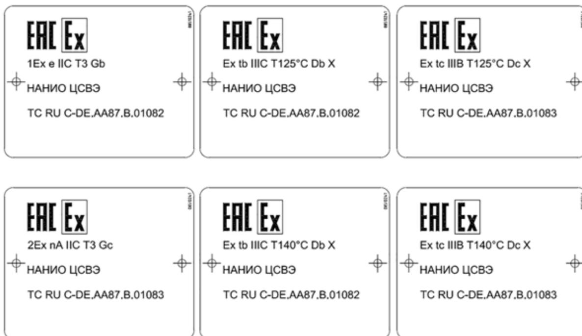
Les moteurs ne doivent fonctionner que dans les secteurs où le type de protection indiqué sur la plaque signalétique du moteur est autorisé. En outre, la classe de température, indiquée sur la plaque signalétique, et la température de surface max. autorisée doivent être impérativement respectées.
