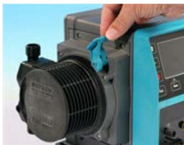
7. Pour dégager la tête de pompe de l'entraînement, tournez la tête de pompe d'environ 15° dans le sens horaire. Remettre le pressostat en « position de transport » (non requis pour CWT).
