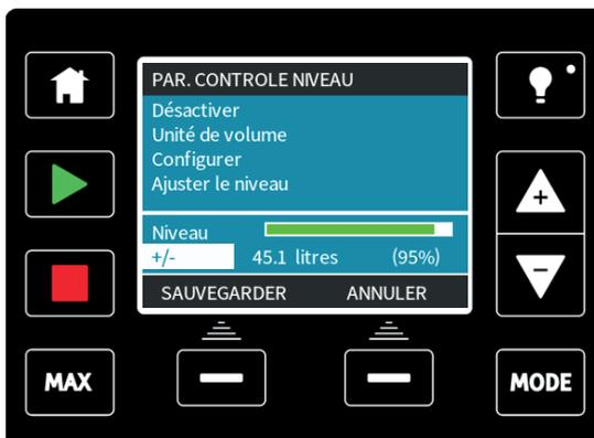
La précision du dispositif de surveillance du niveau de fluide s'améliorera au fil des calibrations de la pompe.
