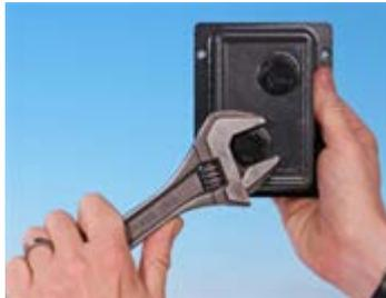
2. Vissez les presse-étoupes 1/2" NPT (avec des rondelles d'étanchéité neuves) à la place des bouchons, en veillant à ce que l'écrou de retenue soit correctement inséré.
