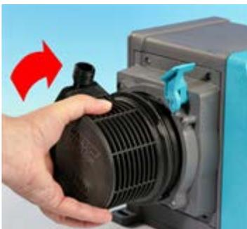
8. Mettez la tête de pompe au rebut conformément à vos propres réglementations en matière d'hygiène et de sécurité. Veillez à respecter les exigences de sécurité relatives aux produits chimiques pompés.
