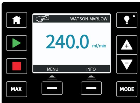
**La pompe est maintenant prête à fonctionner sur la base des paramètres usines indiqués ci-dessus.**
