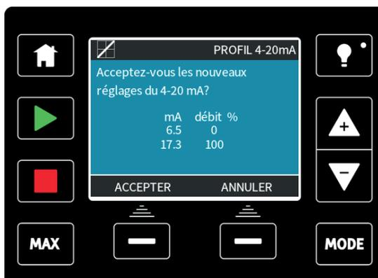
Appuyez sur **ACCEPTER** pour confirmer les nouvelles valeurs du PROFIL 4-20 mA. Cela n'aura pas pour effet de modifier les points A et B enregistrés, le facteur de multiplication sera adapté pour le profil 4-20 mA. Pour réinitialiser les débits d'origine, remettez le facteur de multiplication sur 1.00.
