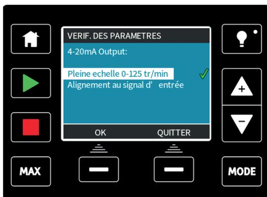
**Pleine échelle** — La sortie 4-20 mA dépendra de la plage de vitesse de la pompe. À 0 tr/min, la sortie de la pompe sera de 4 mA. À la vitesse maximale, la sortie de la pompe sera de 20 mA.
