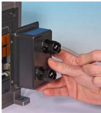
**Note : Si le cordon utilisé est très raide ou d'un diamètre important, il pourrait s'avérer plus pratique de dénuder le fourreau extérieur avant de faire passer les conducteurs du câble à travers le passe-étoupe.** Néanmoins, pour garantir une parfaite étanchéité, le fourreau du câble doit être intact à l'intérieur du presse-étoupe, au moment du serrage.
