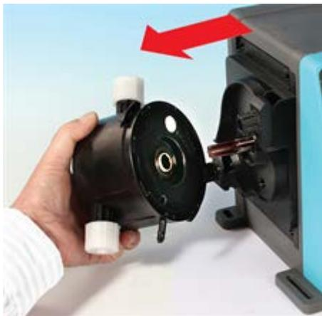
9. Mettez la tête de pompe au rebut conformément à vos propres réglementations en matière d'hygiène et de sécurité. Veillez à respecter les exigences de sécurité relatives aux produits chimiques pompés.
