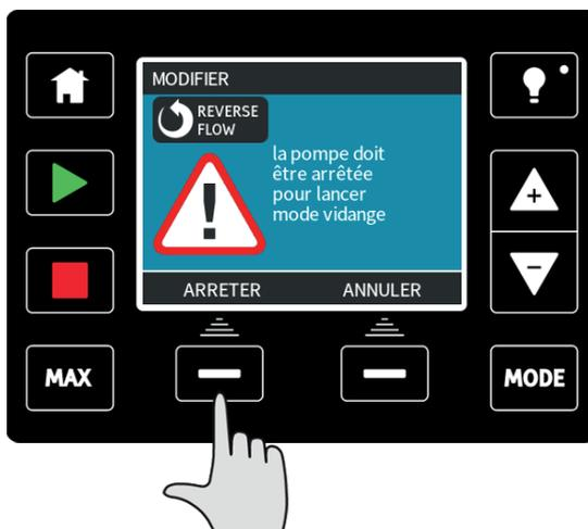
Un message s'affiche alors à l'écran. Il s'agit d'un avertissement visant à s'assurer que votre système est compatible avec le débit inversé. Si la pompe est dotée de vannes unidirectionnelles, le débit ne peut être inversé et la pompe risque d'accumuler une pression excessive dans ses conduites.
