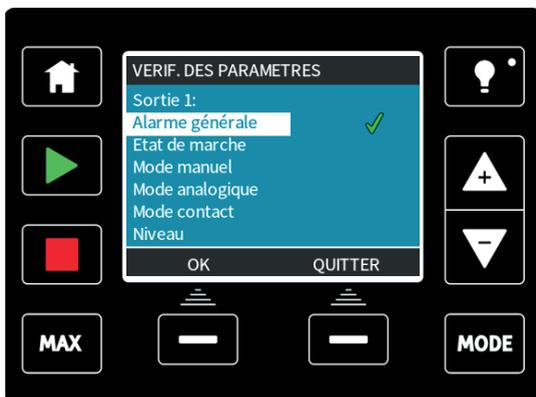
À l'aide des touches +/- et **SÉLECTIONNER**, indiquez l'état de la pompe souhaité pour la sortie sélectionnée. La coche indique le paramètre actuel.
