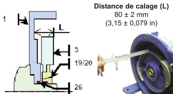
9. Serrer progressivement les vis **20a**, en s'assurant que l'alignement de la roue est conservé.
