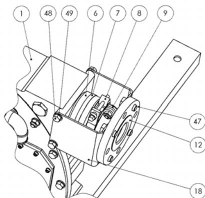
8. Fixer la bride **47** sur les étriers **18**, à l'aide de 2 vis **98** et 2 écrous **99** diamétralement opposés.
