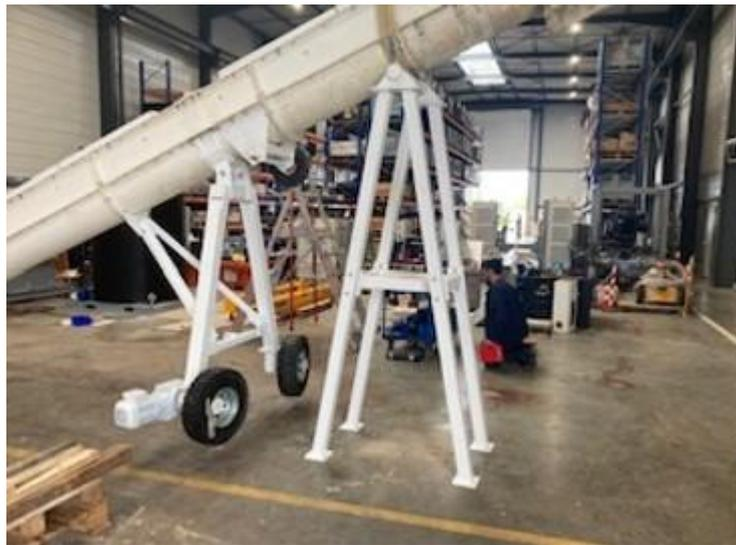
*Figure 16. Chandelle de support provisoire*
