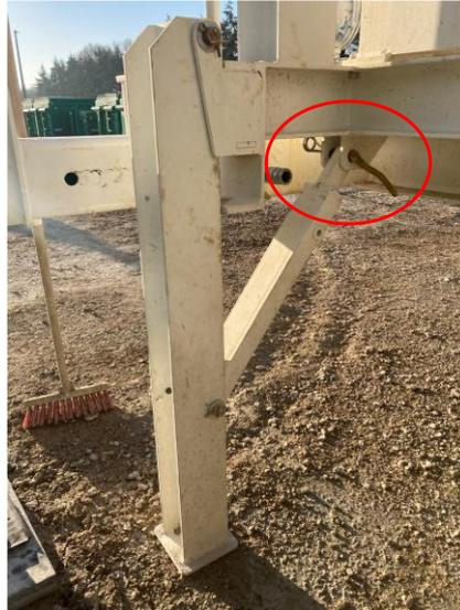
**Figure 30 : Pieds avant en configuration production**
