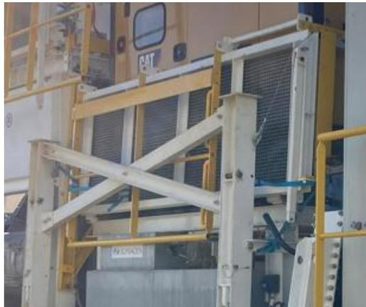
Figure 35 : Passerelle du GE en config transport
