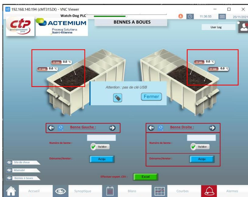
Figure 48 : Relevé des températures dans les bennes de sortie
