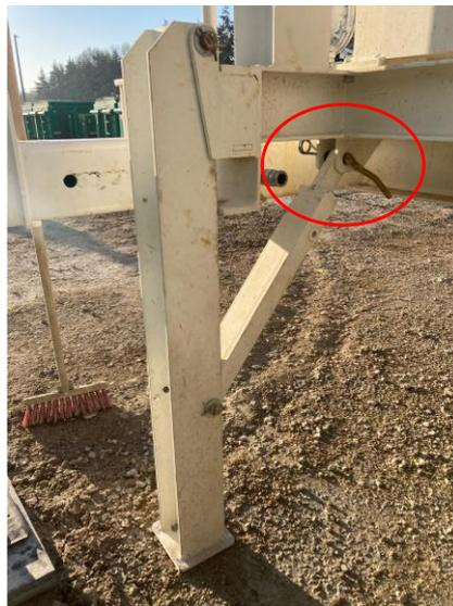
**Figure 55 : Pieds avant en configuration production**
