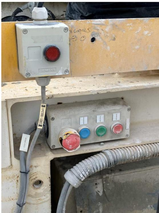
Figure 3. Boîte à bouton ouverture trémie et arrêt d'urgence
