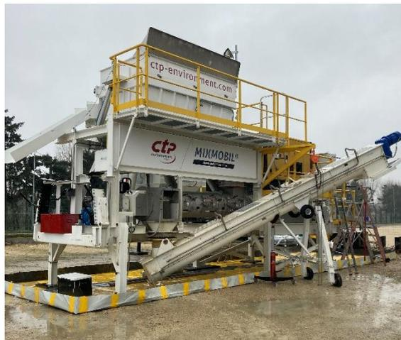
**Figure 39 : Convoyeur en configuration production**
