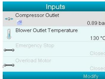
Le premier élément de la liste est surligné. Dans cet exemple, la Sortie du Compresseur est sélectionnée (icône Graphique). Pour changer, appuyer une nouvelle fois que le bouton Entrée et une fenêtre pop-up s'ouvrira :
