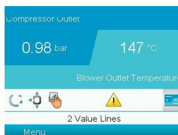
A l'aide des touches de défilement (12), sélectionner l'icône d'avertissement (1) et appuyer sur la touche Entrée (10) pour voir le menu Protections.
